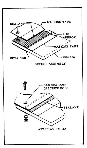
Figure 18-9. Window Sealing
