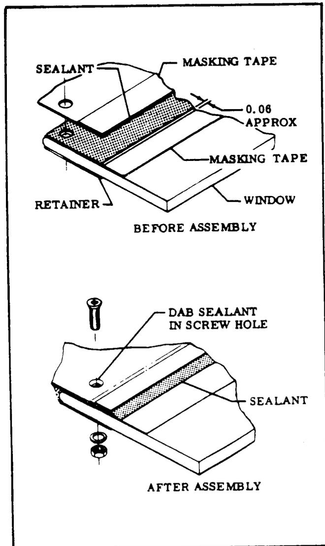
Figure 18-9. Window Sealing
